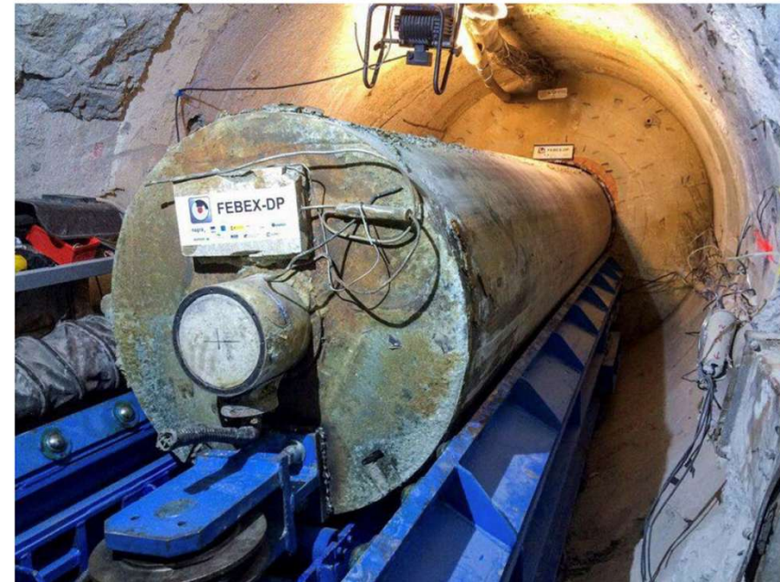
Figur 176-2: FEBEX-DP Experiment im Felslabor Grimsel (Kober et al. 2021). Zu sehen ist ein rückgebautes Heizelement mit Sensoren nach ca. 18 Jahren Heizphase. Im Hintergrund ist der noch mit Bentonitblöcken verfüllte Stollenabschnitt des Heizexperimentes ersichtlic.
