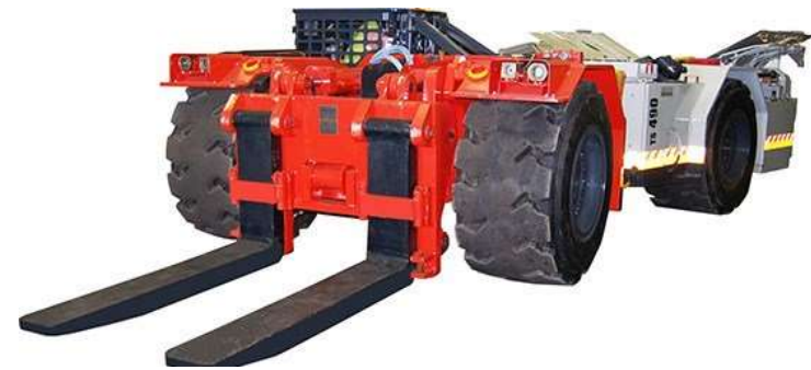
Sandvik TS490L: Dimensionen (L-B-H): 10.1 x 3.3 x 1.65 m Nutzlast: 40 t
